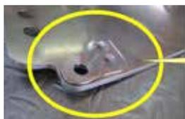
取り付けボルト部分だけ二重にして強度を上げます
