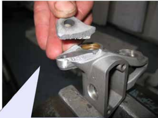
上下の差し込み部が折れました
