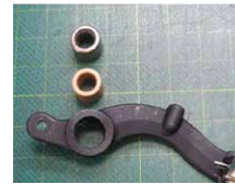
※ Sherco と Scorpa はブレーキハブが鋼カラーです。穴径を広げ、これをオイルシール付きのローラーベアリングに変更。 ベアリング込み..... 3,000 円
