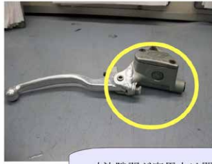
寸法隙間が実用上は問題ないレベルに、見かけはどうあれ、溶接修理出来ました。
