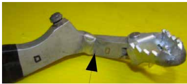
治具で付け根と先っぽを正しく固定して溶接しますので踏むペダル位置は正しく出ます
