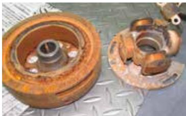
絶縁して巻き付けているコード皮膜がサビでむき出しになりショートします。電気系は壊れると修理は不可能で あげく高価ですよ。
