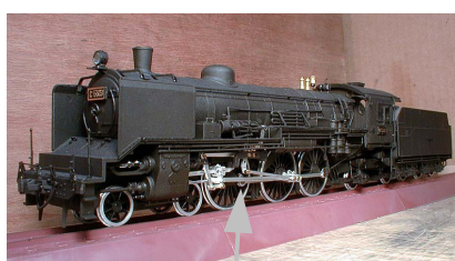
車輪と車輪をつないでいるのは左右に動くからロッドです
